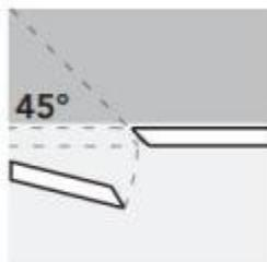
**Ante a battente / Hinged doors** consente di aprire simultaneamente entrambe le ante. La battuta delle ante a 45° è realizzata per ridurre al minimo l'ingresso di polveri.
