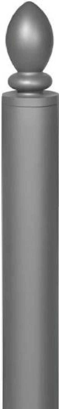
Borne de délimitation avec structure tubulaire en acier d'épaisseur 3 mm et de diamètre 60 mm. Hauteur hors sol: 1006 mm
